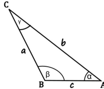
**Ejemplo resuelto 1:** resolver el triángulo oblicuángulo y calcular su área conociendo las medidas de un lado ( $a = 30$  m) y de los dos ángulos adyacentes al mismo ( $\beta = 68^\circ 10'$  y  $\gamma = 15^\circ 20'$ ).
