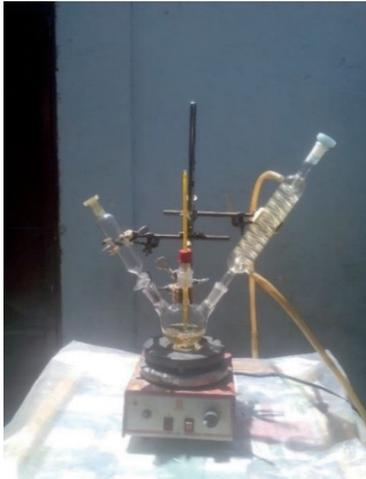
**Figura 1:** Montaje experimental utilizado para las reacciones foto-Fenton.
