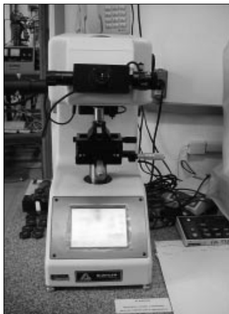
FIGURA 3 (izq.). Microdurómetro Buehler. FIGURA 4 (der). Micrografía de aleación ZA27+7% Si+2.5% Cu.
