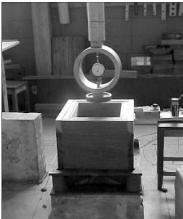
**FIGURA 2:** Prensa construida en el “Laboratório de Madeiras e Estruturas de Madeira”
