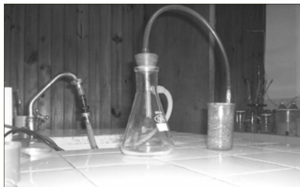
FIGURA 1. Dispositivo utilizado en la extracción de los solubles para simular la mateada.
