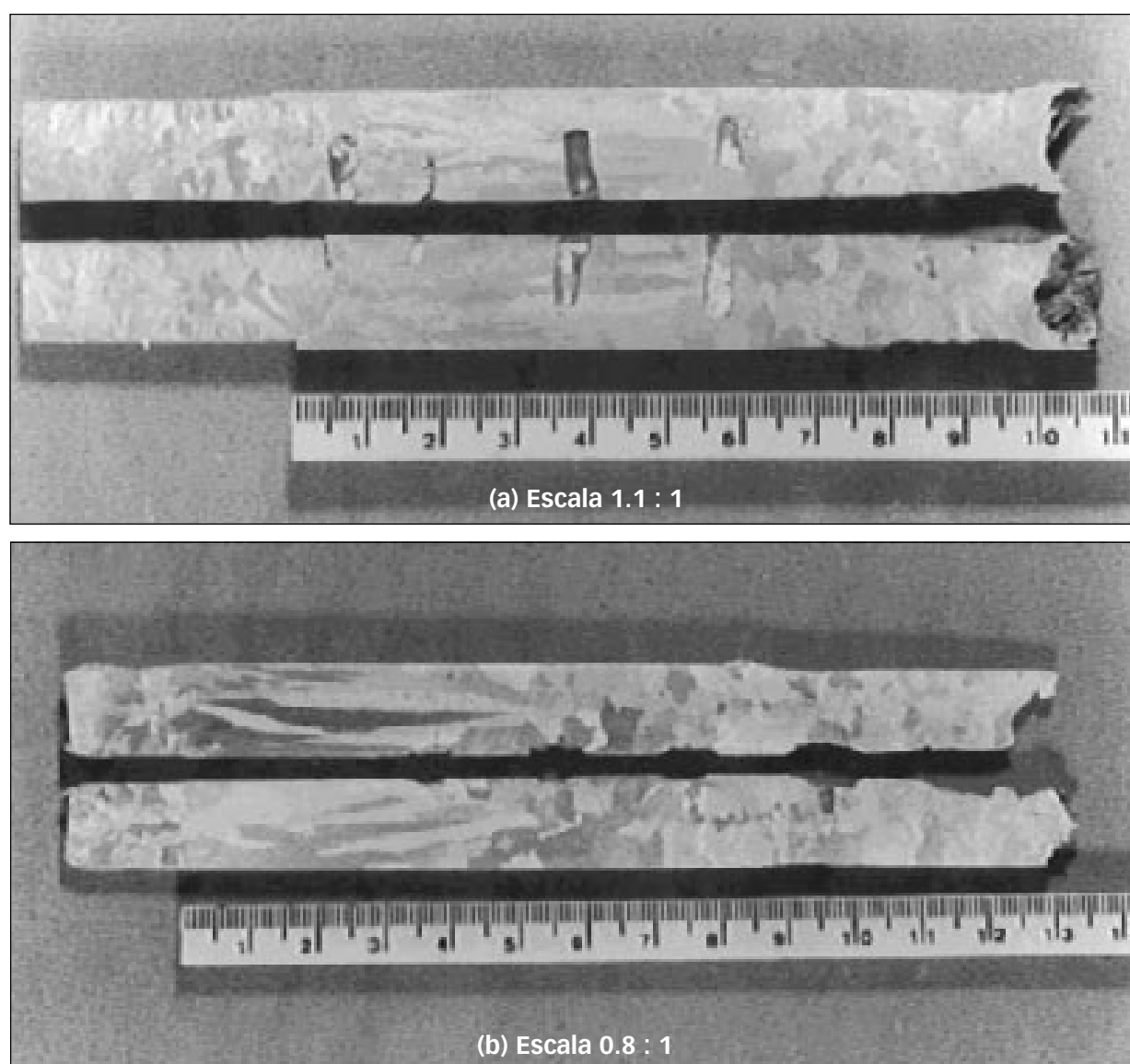
FIGURA 2: Macrografías correspondientes a probetas de distintas aleaciones. (a) Experiencia N°2. Al-10%wtSi-2.5%wtCu. (b) Experiencia N°4. Al-2%wtCu
