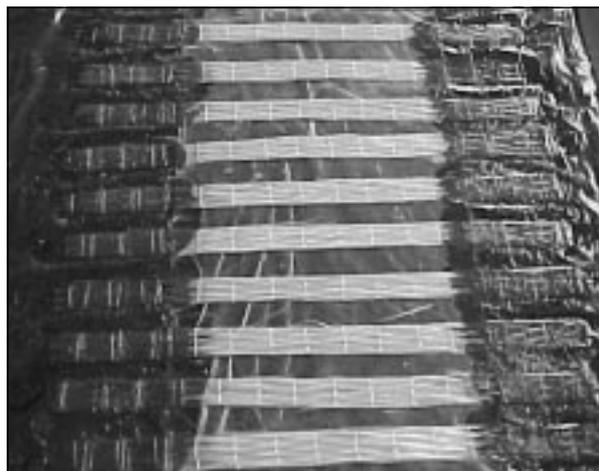
FIGURA 4: Probetas de fibra de vidrio sin resina
