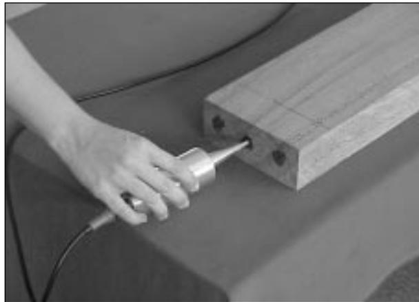
**FIGURA 3:** Posición de los transductores y visualización de los tres puntos analizados.
