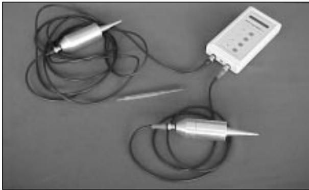
**FIGURA 2:** Equipo SYLVATEST utilizado para la obtención del coeficiente de la matriz de rigidez de la madera.
